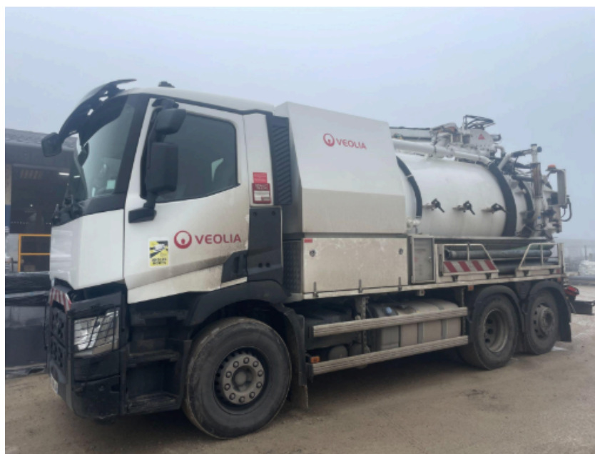
Figure 24. Photographie du véhicule hydrocureur utilisé pour l'hydrocurage des réseaux sur le périmètre de la CA2BM Source : Veolia (2025)
