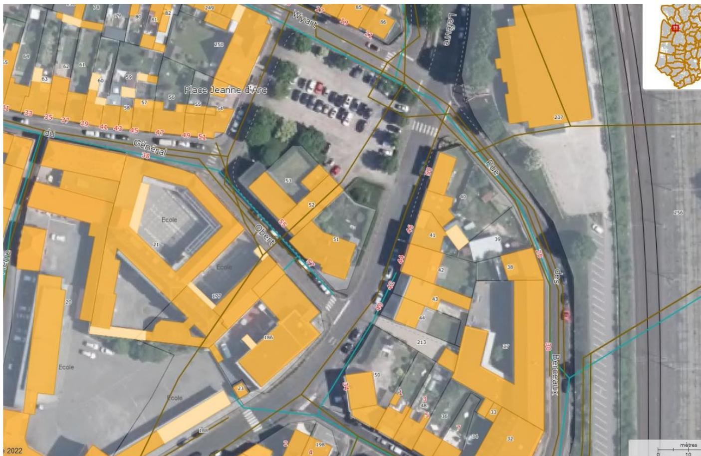
Sur le SIG de la CA2BM, les réseaux assainissement semblent traverser sous le bâtiment.
